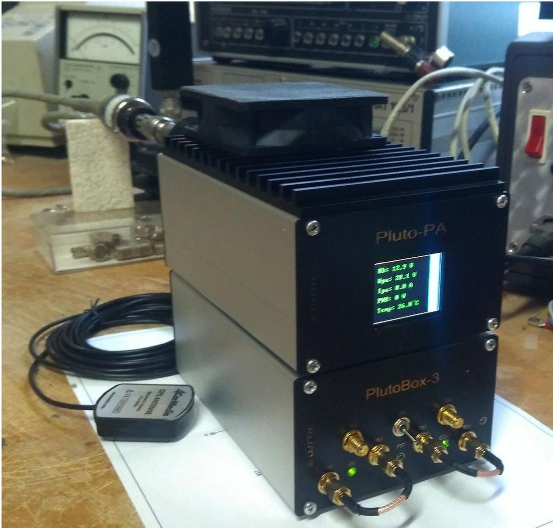
PA im Testbetrieb am HP-Leistungsmesser
