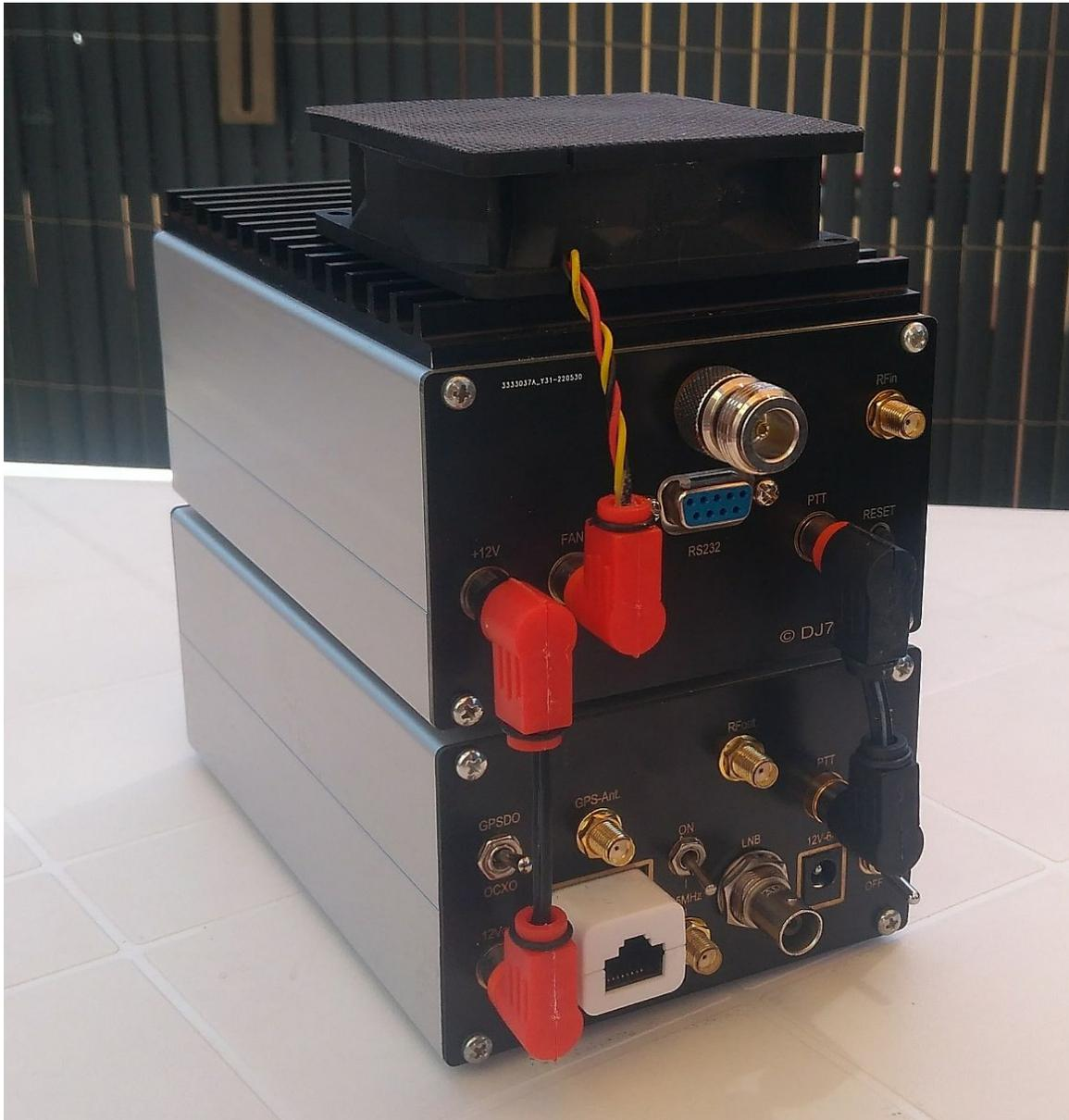
Auf der Backplane findet man die Anschlussbuchsen für +12V, PTT, externer Lüfter, RF-Input, RF-Output sowie ein RS232-Port zur optionalen Datenübertragung und den Reset-Taster.
